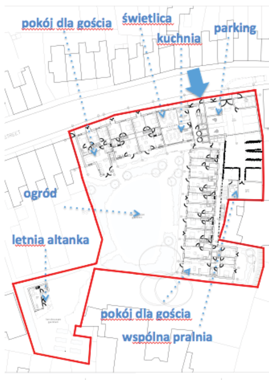
Rys. 2 Przykładowy projekt architektoniczny cohousingu z naniesionymi funkcjami
